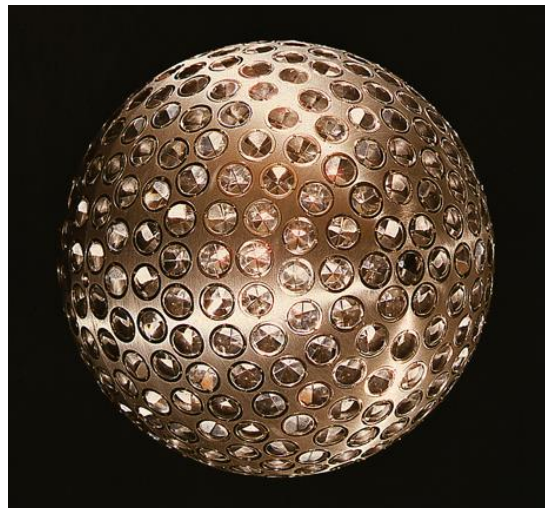
Abbildung 2-1 LAGEOS, gemacht für SLR [Wikipedia: LAGEOS]
